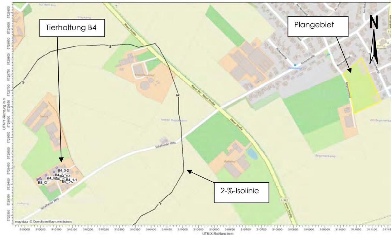
Abbildung 6: Gesamtzusatzbelastung IGZ<sub>b</sub> Betrieb B4, genehmigter Zustand, Isolinie in % der Jahresstunden
